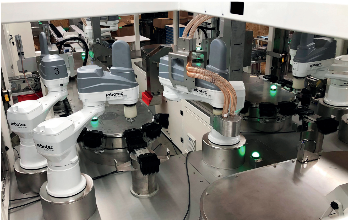
Anlage zur Prüfung, Bestückung und Verpackung von in 96er-Trays aufgereihten Pipetten für die Labordiagnostik © Robotec
